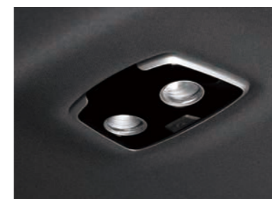
LED osvetlenie interiéru
