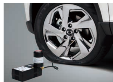
Súprava na opravu pneumatík
