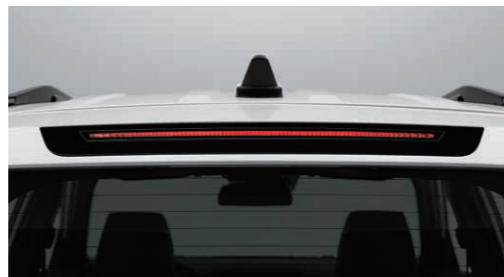
Horné LED brzdové svetlo
