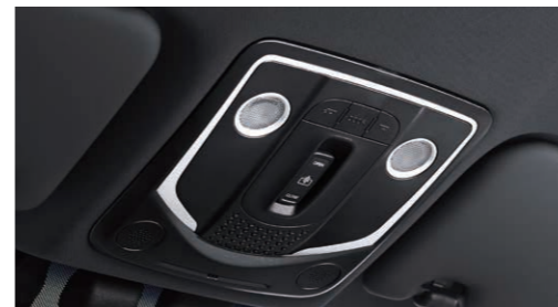
Ovládací panel nad hlavou vodiča a spolujazdca s dotykovým ovládaním vnútorného osvetlenia a strešného okna
