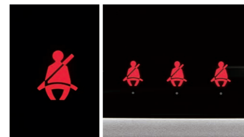
Signalizácia nezapnutia bezpečnostných pásov
