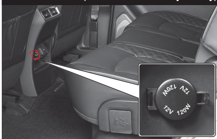
Elektrická zásuvka (zadná strana stredovej konzoly)
