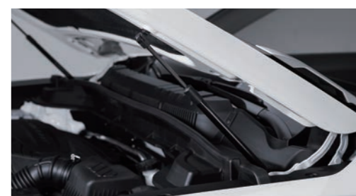
Podpery kapoty so vzduchovými tlmičmi
