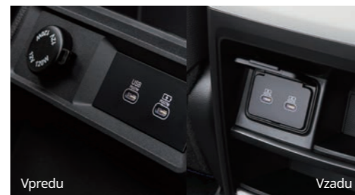
12 V výstup a nabíjacie USB konektory
