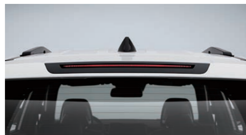
Zadný spojler so zabudovaným LED brzdovým svetlom
