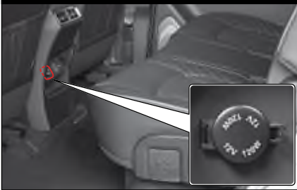
Elektrická zásuvka (zadná strana stredovej konzoly)
